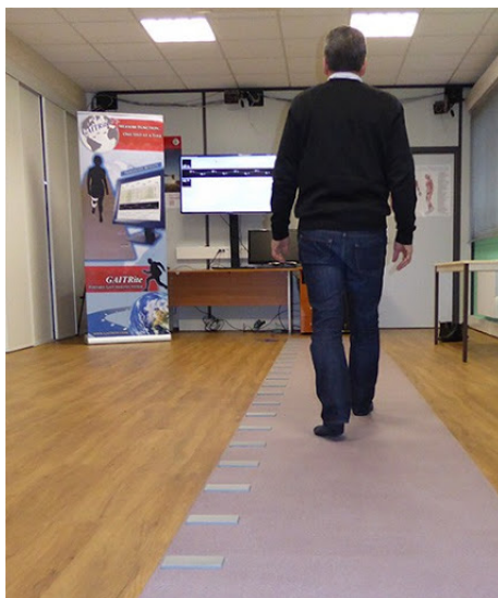
FIGURE 4.1 – Tapis GAITRite utilisé pour l'analyse de la marche au sein du protocole d'essai clinique Doktor BRAU. Image extraite du site internet du fabricant : www.biometrics.fr
